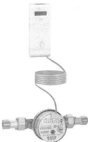
**MONITOR 2.0 PULSE** sono gli acquisitori di impulsi che abbinati ad un contatore d'acqua calda e/o fredda sanitaria dotati di sistemi lancia impulsi, permettono la rilevazione dei consumi d'acqua sanitaria per la contabilizzazione delle spese per singolo alloggio.
