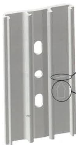
L'indicatore di posizionamento del ripartitore deve essere SEMPRE collocato esattamente al 75% ( $\pm 1$  cm) dell'altezza del corpo scaldante.
