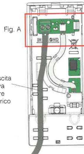
Cavo uscita impulsiva contatore volumetrico
